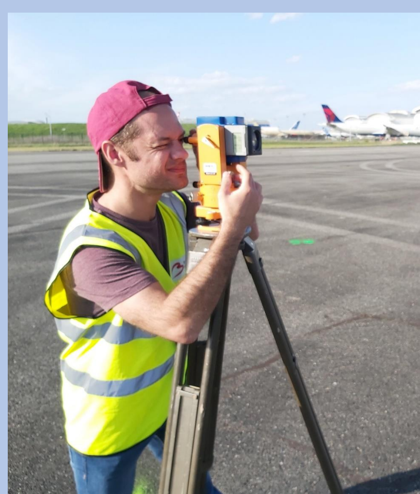
Gauches: opérateur effectuant une mesure de déclinaison magnétique. Centre: levé magnétique en vue d'établir une nouvelle plateforme de calibration de compas (plateforme de compensation). La zone est polluée par des canalisations en béton armé. Droite: résultat de la calibration d'une plateforme de compensation.
